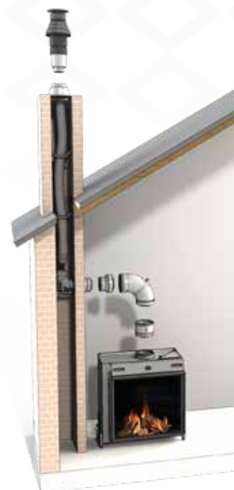
Über das Dach • flexibles Rohr im Schornstein
